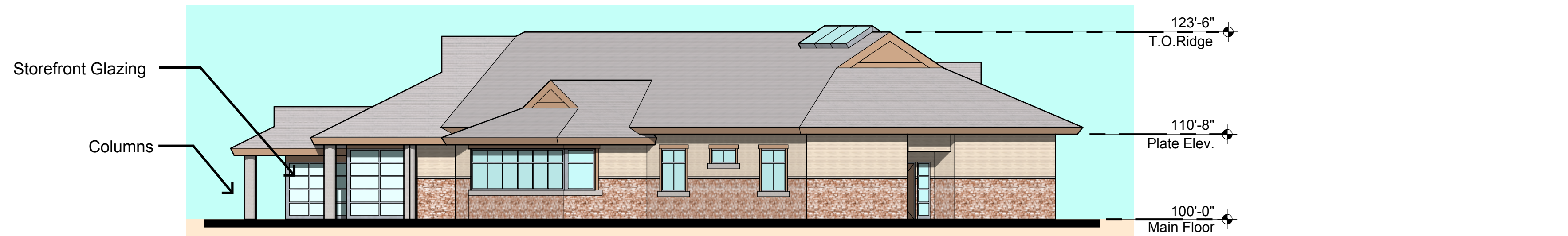
(D) 3 WEST ELEVATION Scale: 3/32" = 1'-0"
